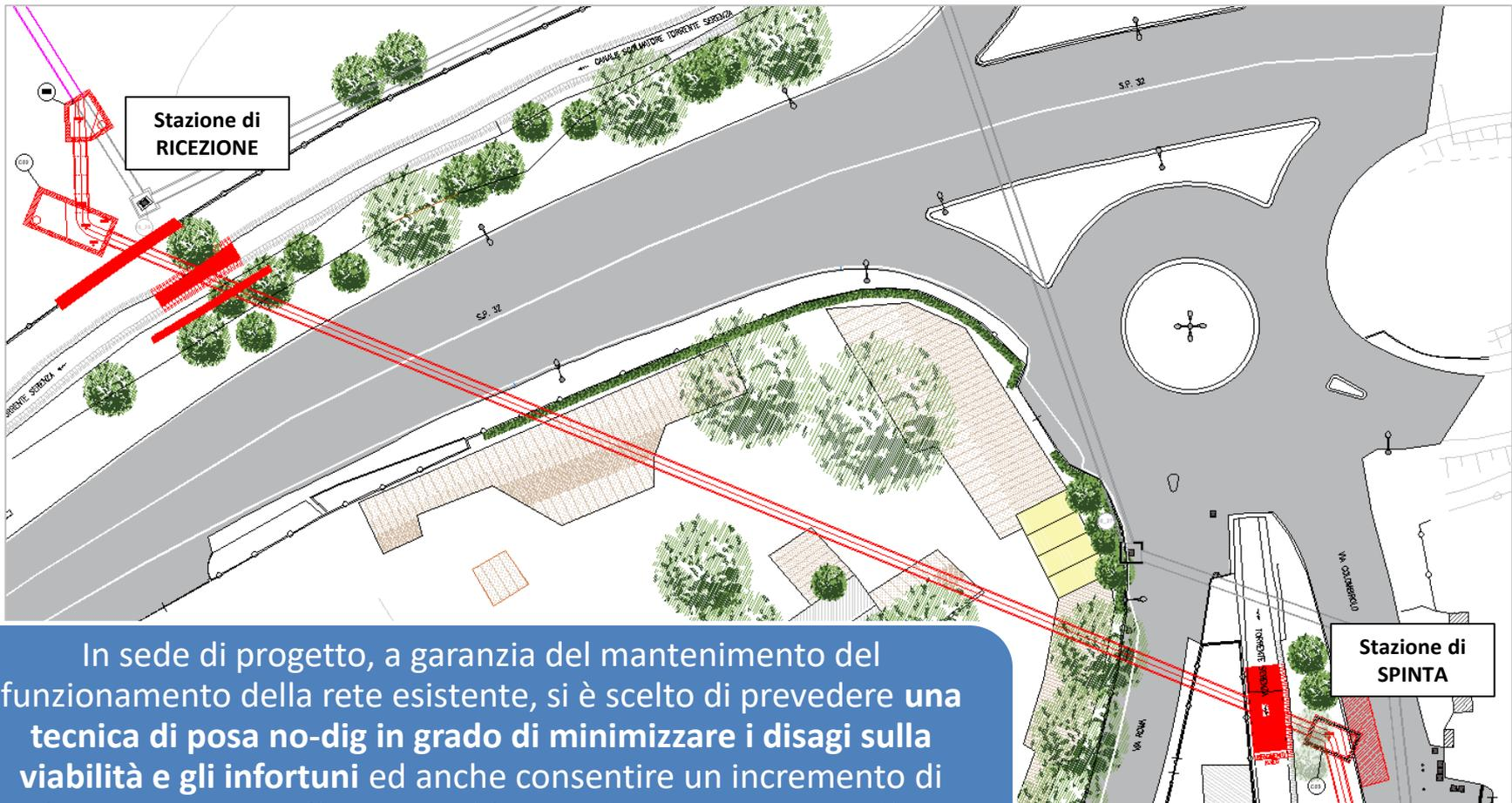
In sede di progetto, a garanzia del mantenimento del funzionamento della rete esistente, si è scelto di prevedere **una tecnica di posa no-dig in grado di minimizzare i disagi sulla viabilità e gli infortuni** ed anche consentire un incremento di diametro rispetto l'esistente (da DN 1000 mm a DN 1200) e pertanto una maggiore capacità di trasporto del collettore.
